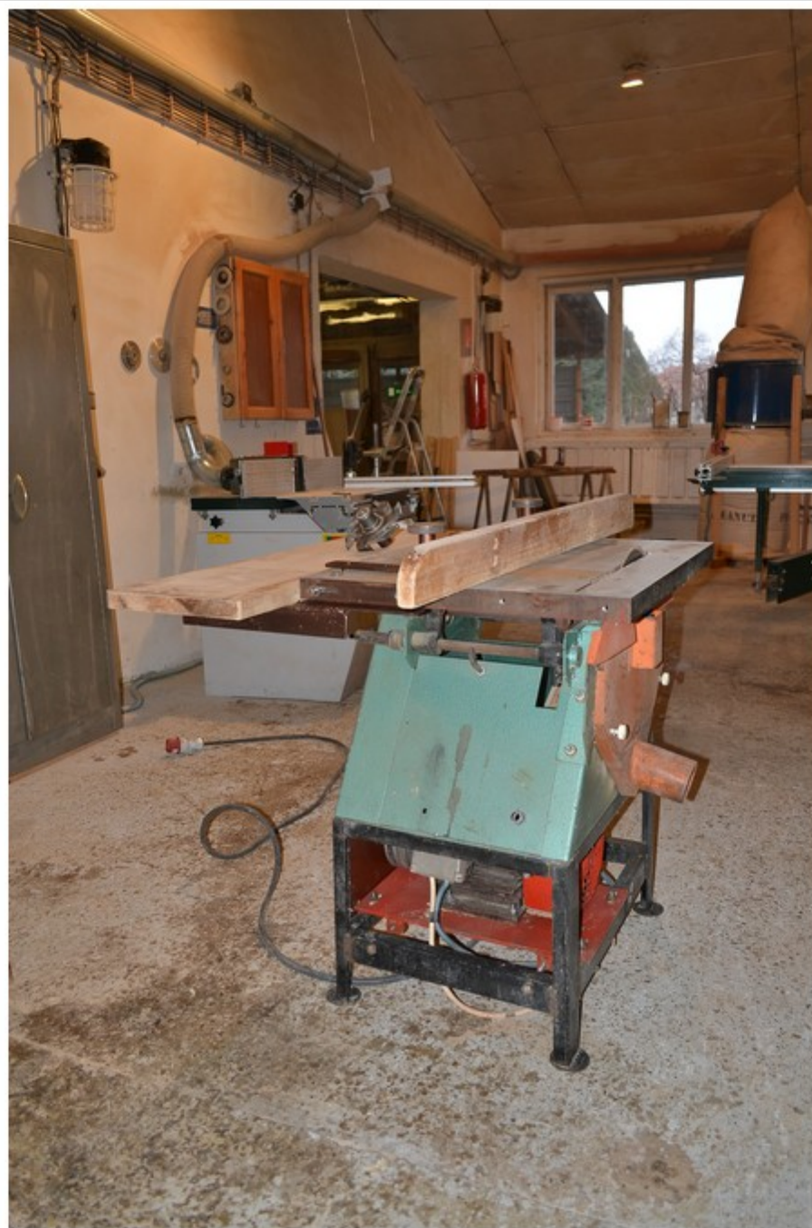
Okružna píla SOP300 s upravou na frezovanie (2)
