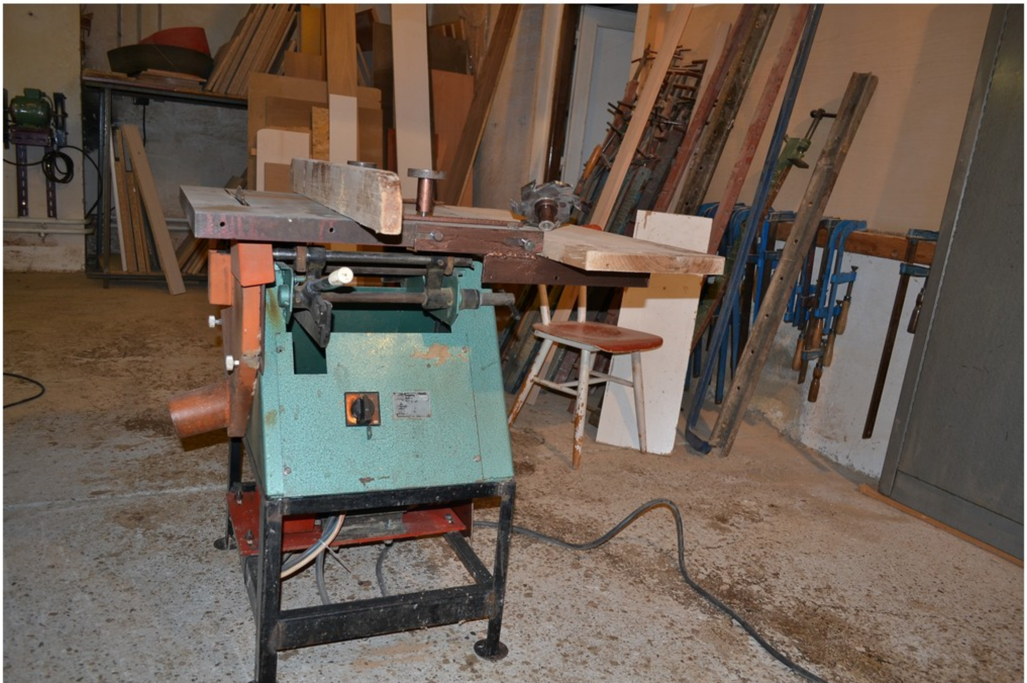
Okružna pila SOP300 s upravou na frezovanie (1)
