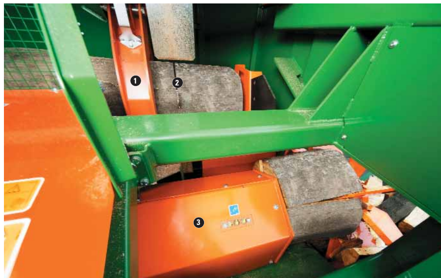
Ústřední část zařízení Spaltfix K-540: dvojitý drapák ① pilová hlavice Harvester s hydraulickým napínáním řetězu a vodící lišty ②. Velký tlačný díl ③ tlačí dřevo štípací silou 35 t proti štípacím nožům s dvojitým řezem.
